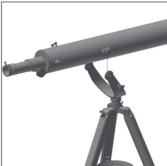
Abb. 4 Befestigung des Rohrs auf der Gabelhalterung.
