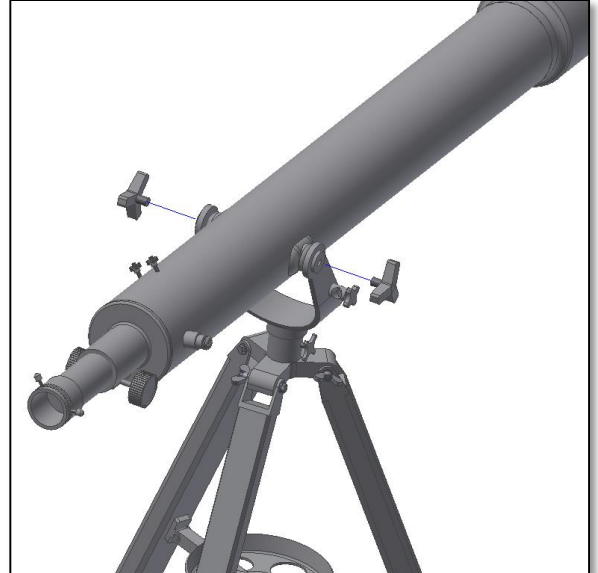
Abb. 5. Sicherung des Rohrs mit den mitgelieferten Stellschrauben.
